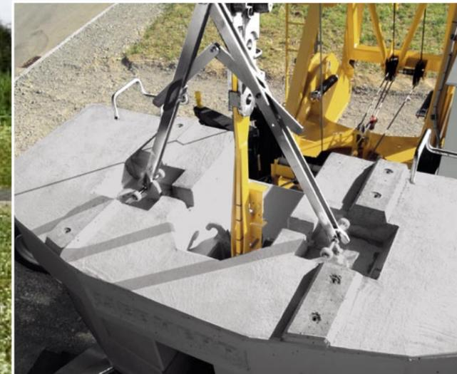
Die halbautomatische Ballastiereinrichtung.
