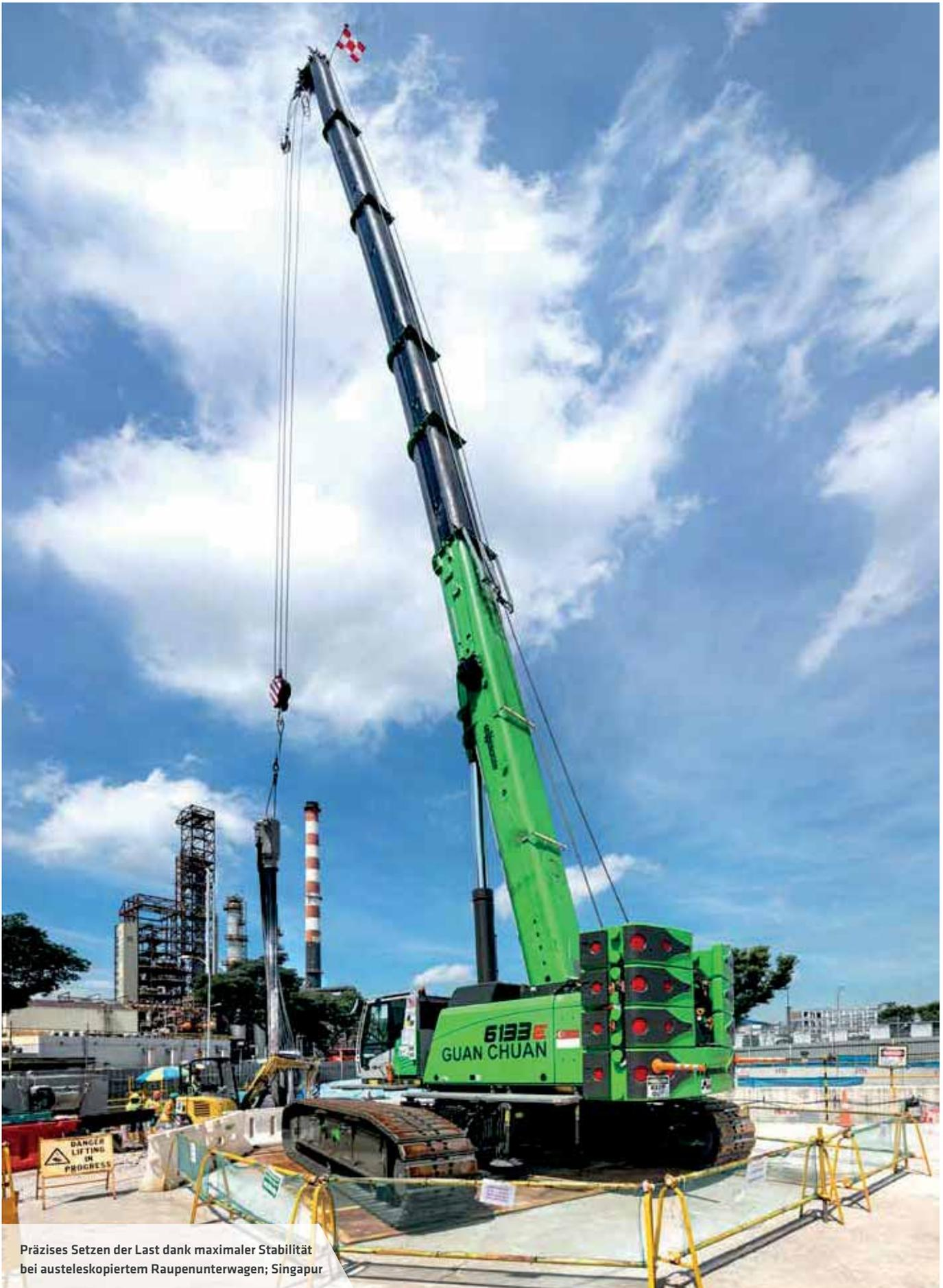
Präzises Setzen der Last dank maximaler Stabilität bei austeleskopiertem Raupenunterwagen; Singapur
